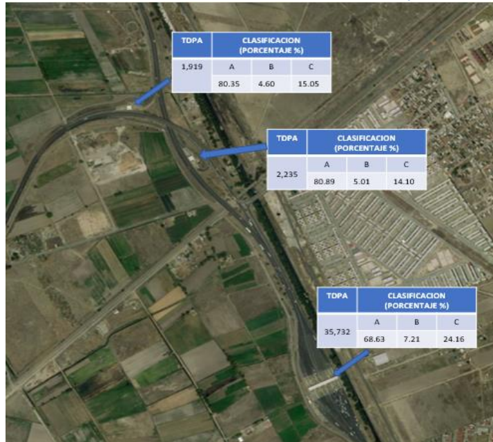
Ilustración 43 TDPA sobre el Circuito Exterior Mexiquense
