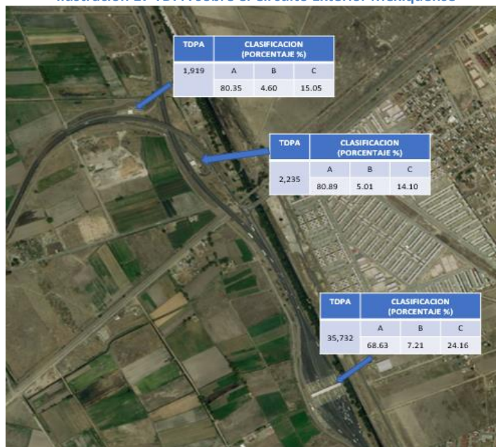
Ilustración 17 TDPA sobre el Circuito Exterior Mexiquense
